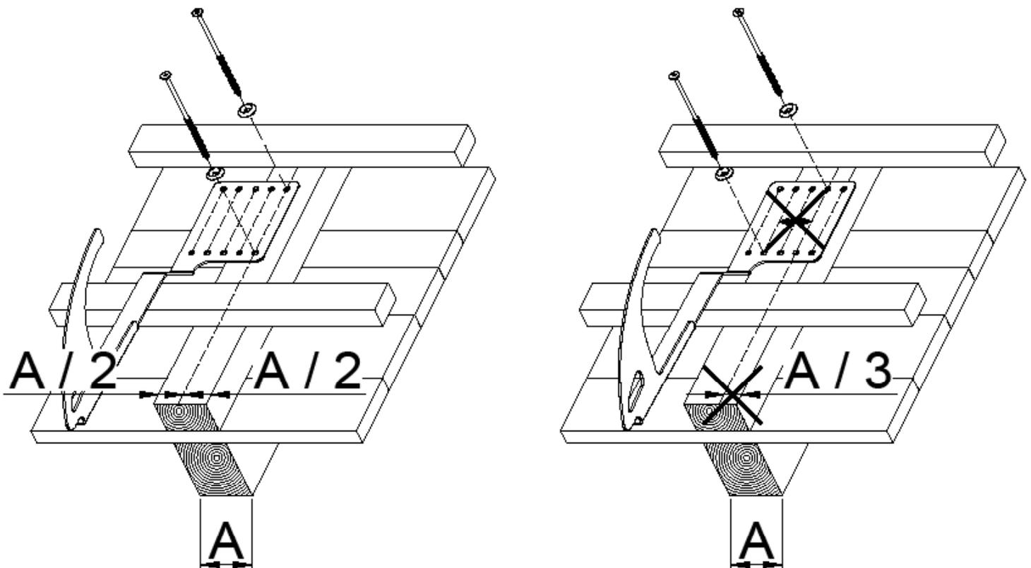
Allineare i ganci per tetto in modo che le 2 viti di fissaggio in dotazione, comprese le rondelle di forma al centro della trave, possano essere fissate una sotto l'altra. A seconda dell'altezza della piastrella, le differenze di altezza possono essere compensate piegando il bordo a Z.
