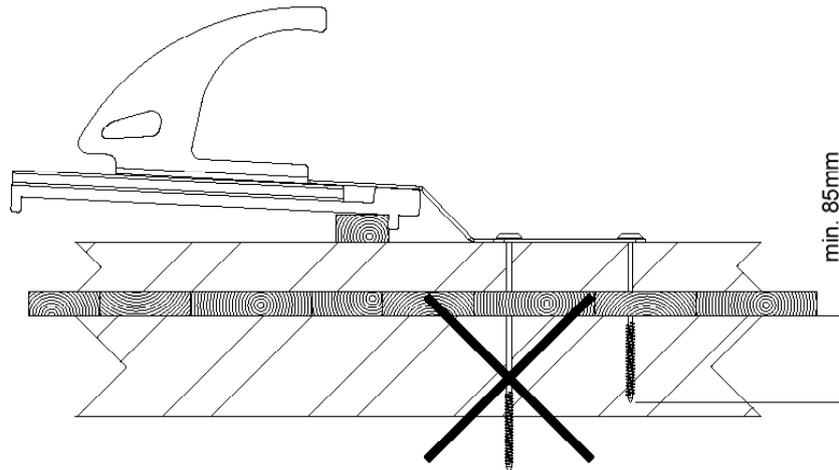
Il fissaggio deve essere effettuato con le viti per legno originali in dotazione, in quanto solo queste possono fornire la resistenza necessaria al supporto.
