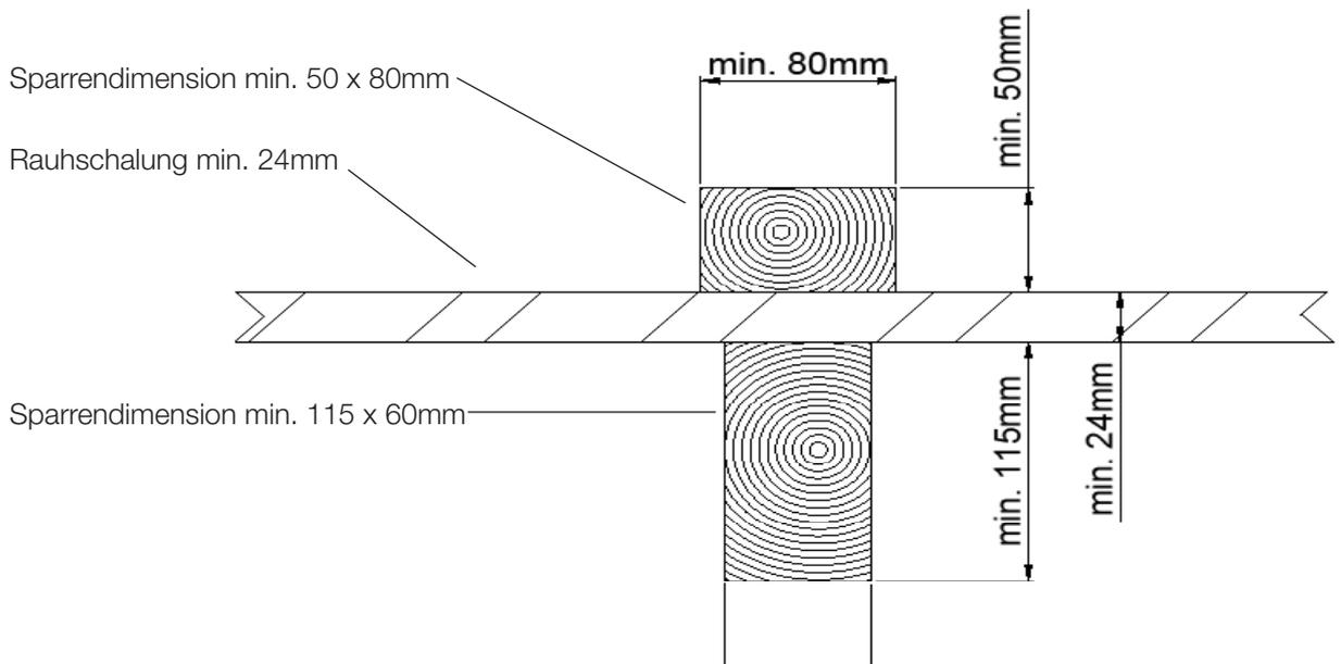
Es muss eine statisch tragfähige Unterkonstruktion vorhanden sein. Im Zweifelsfall ist ein Statiker hinzuzuziehen.
