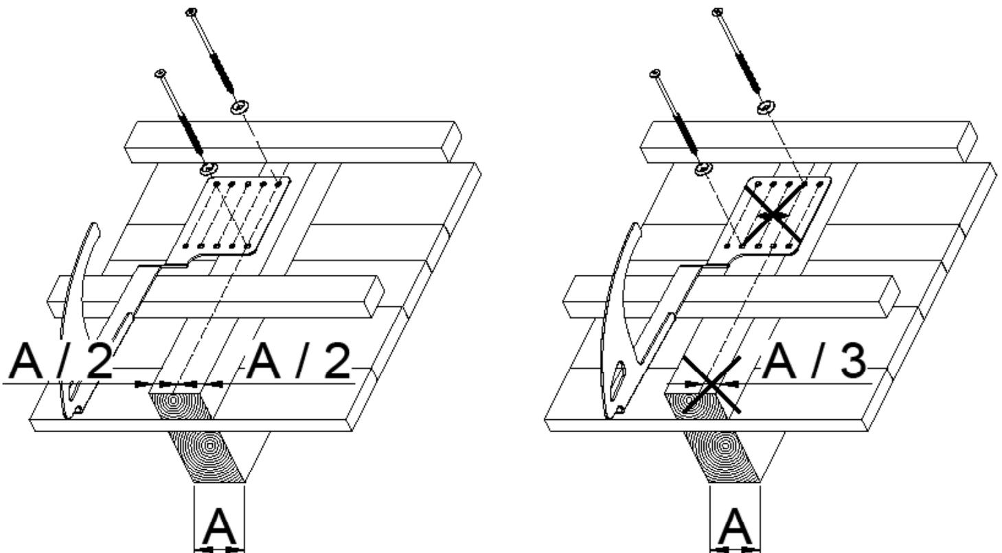
Richten Sie den Dachhaken so aus, dass die 2 Stk. mitgelieferten Befestigungsschrauben inkl. Fassonscheiben in der Mitte des Sparren, untereinander befestigt werden können. Je nach Höhe des Ziegels sind Höhenunterschiede durch biegen der Z-Kantung auszugleichen.
