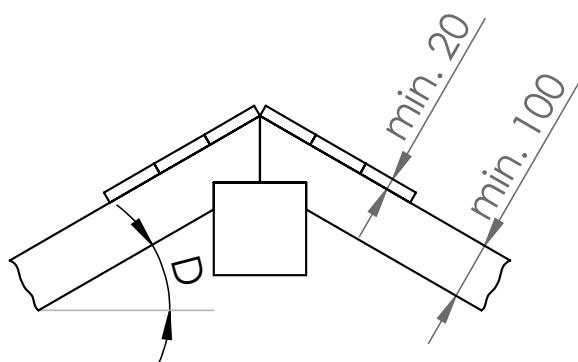
$D = \text{min. } 18^\circ / \text{max. } 48^\circ$
